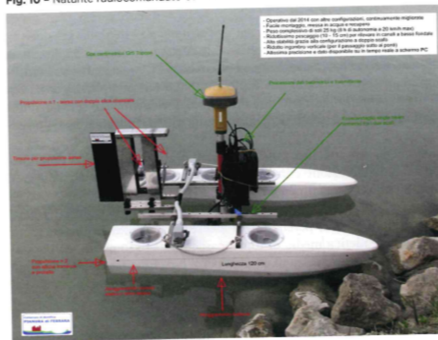
Fig. 10 - Natante radiocomandato con sonar e GPS centimetrico.
